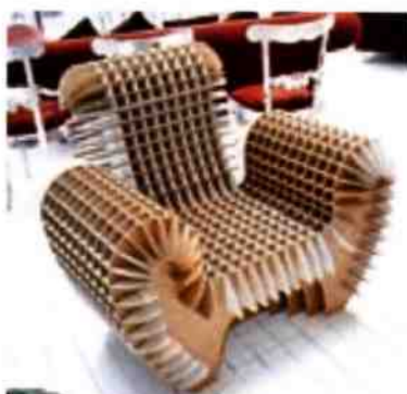
Poltrona "Frame" ideata da Martino Zinzone e realizzata grazie al taglio di sette pannelli di cartone BC "Frame" armchair created by Martino Zinzone and made by cutting seven BC cardboard panels
